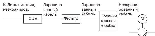
Рис. 43 CUE и фильтр установлены на расстоянии от скважины
