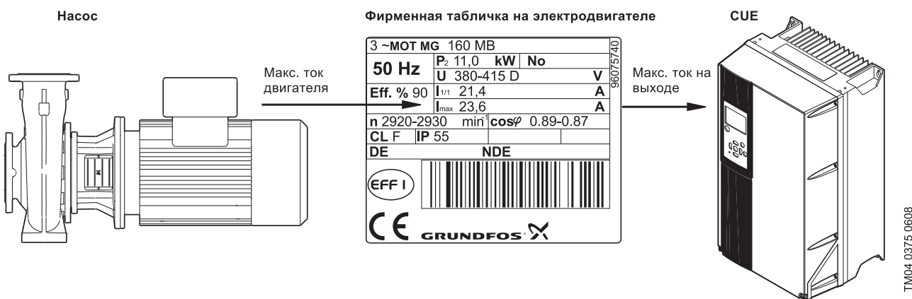
Рис. 45 Подбор CUE на основании максимального тока двигателя.
