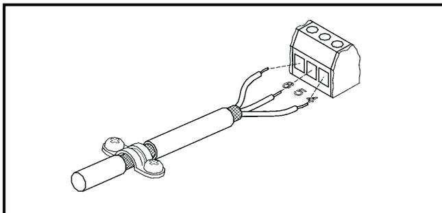
Для подключения к шине связи требуется применение двухжильного экранированного кабеля. Экранирующая оболочка должна с обоих концов подключаться к зажиму  $\Upsilon$ .
