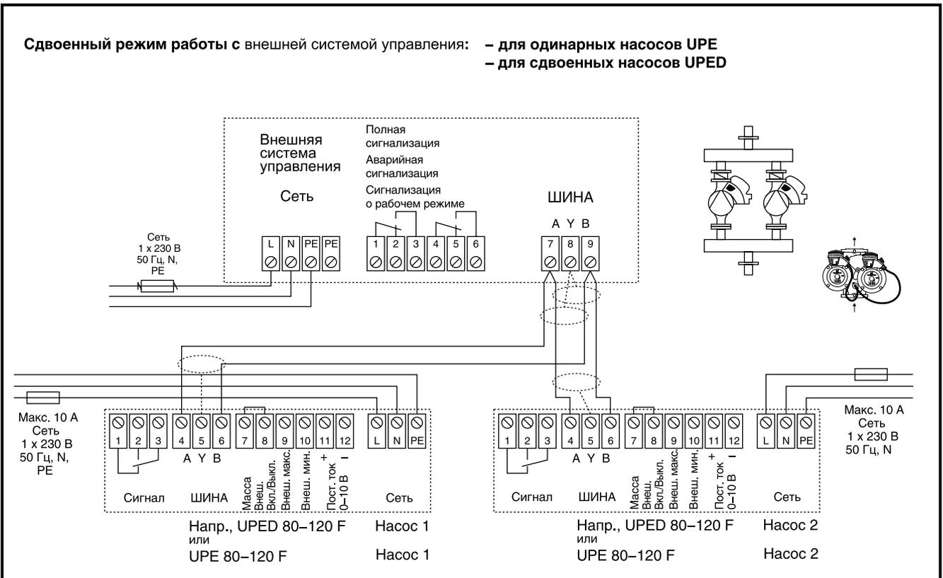
3. UPED 80–120 F в качестве сдвоенного насоса в одиночном режиме (одновременно или при необходимости)
