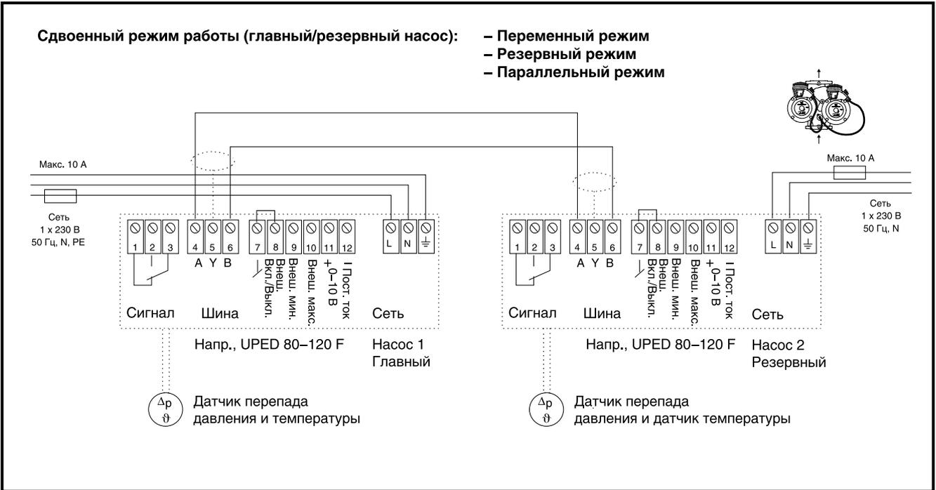
2. UPED 80–120 F используется в качестве сдвоенного насоса в переменном режиме, резервном режиме (главный и резервный насос) или параллельном режиме одновременно с
