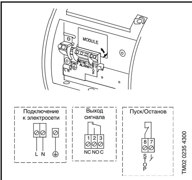
Подключение **одиночных насосов** выполняется согласно представленной здесь схеме. Если речь идет о **сдвоенных насосах**, то к электросети должны подключаться оба электродвигателя.
