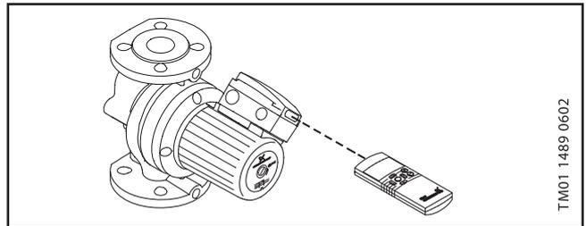
Модуль шины связи GENI позволяет осуществлять связь с инфракрасным прибором дистанционного управления R100.
